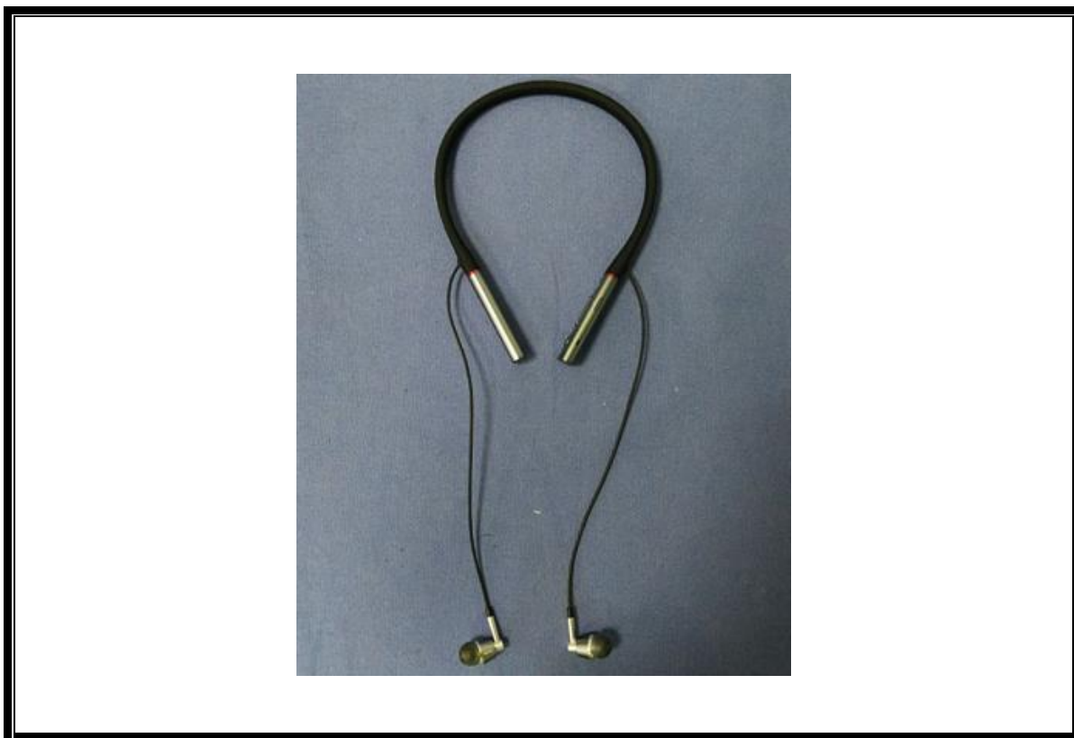
整体照 物理尺寸：长 X 宽 X 高= 330 mm(L)X 130 mm(W)X 20 mm(H)
