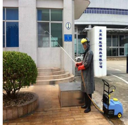
图片 2 水雾灭火器 (穿着 PPE 防止触电)
