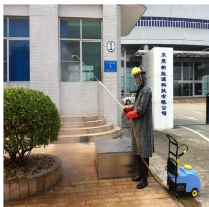
图片 2 水雾灭火器 (穿着 PPE 防止触电)
